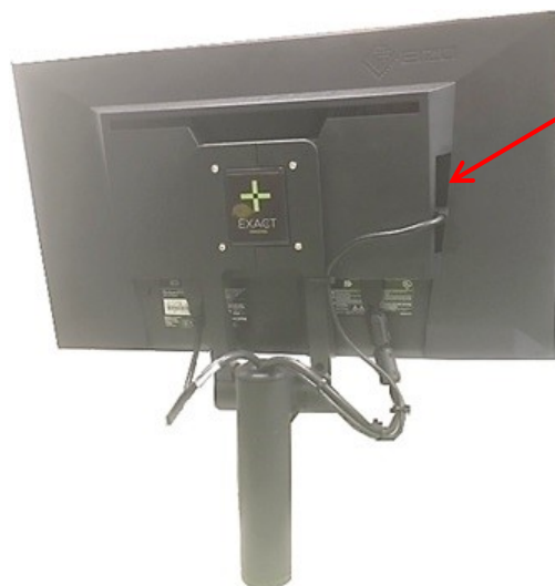
Figura 8: Conectores USB na parte traseira do monitor (disponível em algumas configurações do sistema ExactVu)
